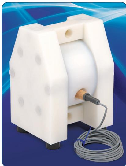
Несмотря на то, что диафрагмы с встроенным металлическим сердечником разработаны из расчета на долгий срок службы, тем не менее они являются изнашивающимися деталями. Когда мембрана рвется, жидкость может протечь в центральный блок и попасть наружу через глушитель. Это можно предотвратить легко и просто, используя систему контроля разрыва мембраны.
