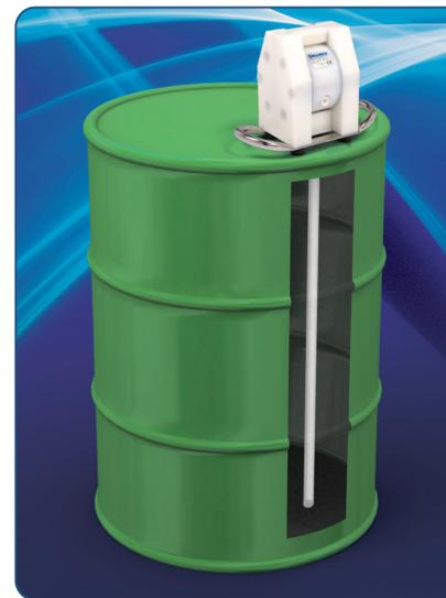
Бочковые насосы DELLMECO изготавливаются из следующих материалов: PE, PTFE (в том числе токопроводящие), алюминий и нержавеющая сталь AISI 316L для наилучшей совместимости с продуктом. Они могут работать с жидкостями с различной вязкостью, которые можно перекачать через трубу диаметром до 1".
