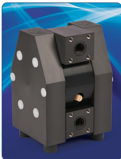
Эта версия дает возможность использовать фланцевые соединения, соответствующие стандарту DIN/PN10. Резьбовые втулки сделаны из нержавеющей стали и вмонтированы в корпус входа/выхода. Предназначены для фиксации фланцев. O-образные кольца прилагаются. Они должны вставляться в углубления в патрубках для лучшего уплотнения соединений.
