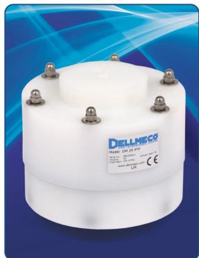
Вначале воздушная подушка в демпфере сжимается благодаря давлению жидкости, которую диафрагма насоса выдавливает вверх. Затем, в момент переключения воздушного механизма насоса, камера демпфера начинает наполняться сжатым воздухом. Воздушная подушка давит на мембрану демпфера в середине такта. В течение данного действия мембрана прогибается не далее среднего положения, амортизирует и сглаживает пульсацию потока.
