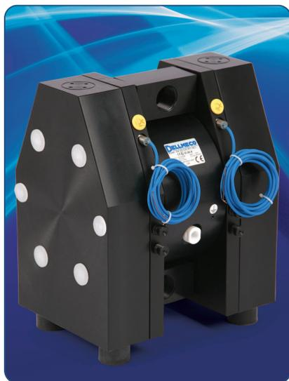
В соответствии со стандартами для высокой степени защиты, в системах с барьерной камерой стандартные мембраны заменяют на, расположенные друг за другом две мембраны и барьерной камерой из токопроводящего PE между ними, заполненной неэлектропроводной жидкостью.
