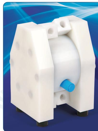
Все модели насосов могут иметь сдвоенные патрубки – код S. Насосы могут быть переделаны из пневматических мембранных двусторонних насосов в два отдельных односторонних насоса. Стандартные патрубки с одним всасывающим входом и одним выходом меняются на патрубки с двойными входом и выходом, таким образом, что для каждой камеры насоса есть отдельно свои вход и выход. По отдельности обе половинки насоса с одним приводом могут качать отдельно сразу две жидкости в равных пропорциях 1 : 1.
